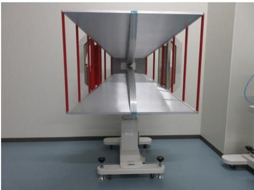
車載電装品向け放射イミュニティ試験用アンテナ
